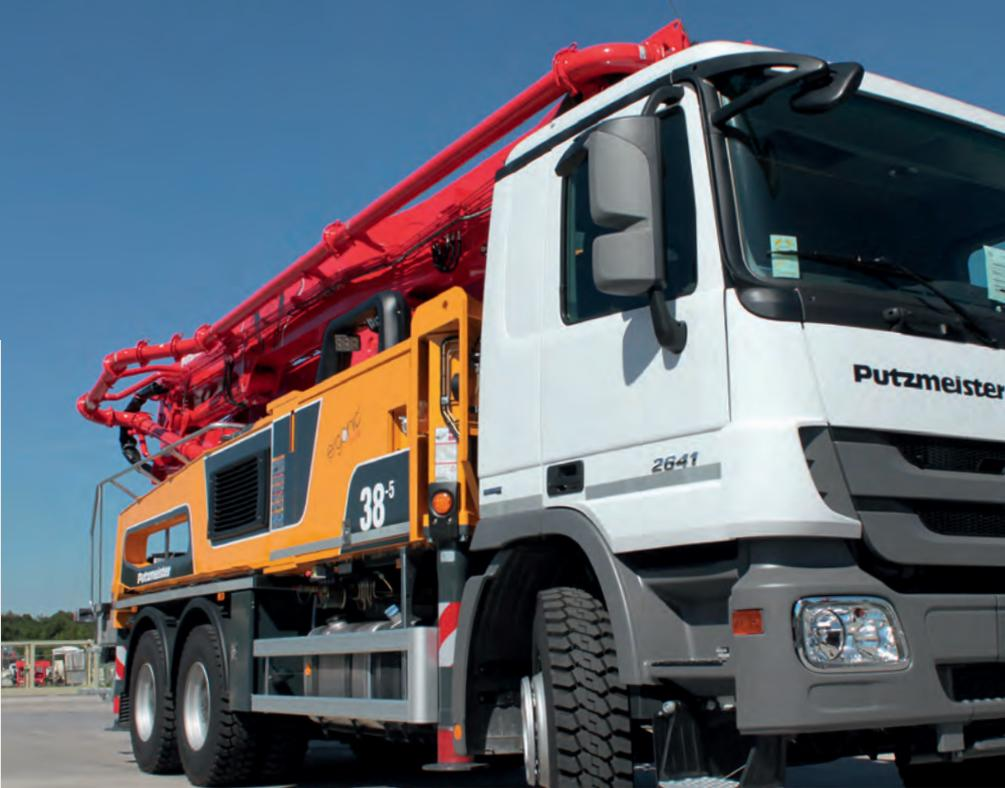
Une fois sur le chantier, cette catégorie de pompes déploie tout son potentiel: les flèches flexibles 4 ou 5 bras peuvent travailler de manière précise dans des halls, tunnels ou sous des ponts, et ce avec une hauteur de dépliage inférieure à 4 m. Elles sont très efficaces sur des chantiers de petite ou moyenne taille.
