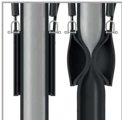
Clapet pneumatique d'arrêt du flexible d'épandage (EQV) pour interrompre le flux du béton et éviter les bavures.
