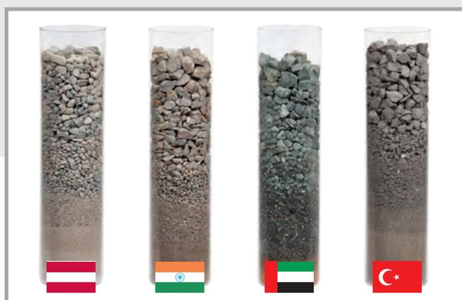
Quelques exemples de mélanges de béton provenant de 4 pays différents (de gauche à droite): granulats ronds d'Autriche, granulats concassés d'Inde et de Dubaï, puis un échantillon de granulats durs et tranchants de Turquie (à droite). Les illustrations montrent les courbes granulométriques du plus fin (en bas) au plus gros (en haut).
