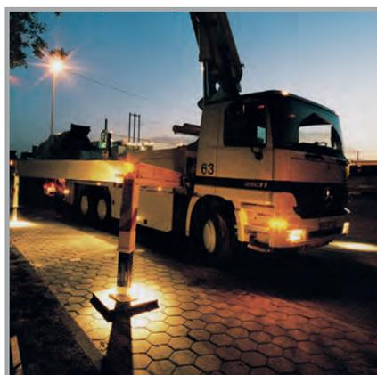
Spots pour éclairer les 4 points d'appui et garantir une mise en place plus sûre et plus rapide lorsqu'il fait nuit.
