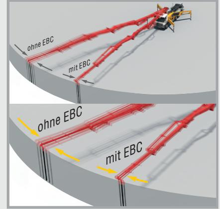
**Base EBC:** le système EBC réduit le mouvement vertical de la flèche à un tiers environ et amortit en parallèle les oscillations du flexible d'épandage dans toutes les directions.
