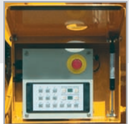
Le poste de commande servant à piloter la machine et à afficher les données de la pompe est de série
