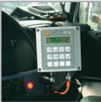
La commande de la bétonnière depuis la cabine est montée de série, elle est différente selon le type de pompe
