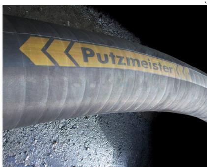
La manguera del rotor es el único elemento de desgaste de la bomba y es muy fácil de cambiar. La manguera está completamente rodeada por una capa protectora de caucho vulcanizado.
