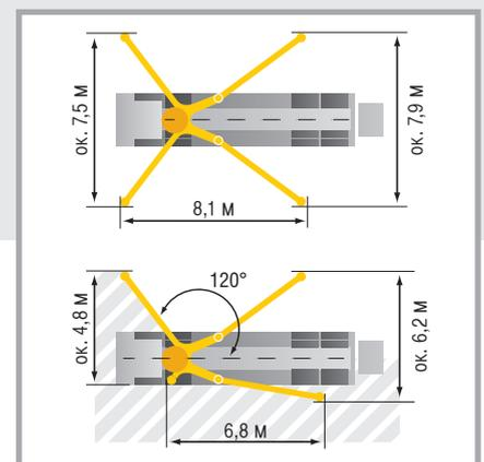
В зависимости от конструкции могут отличаться размеры. Общий вес в зависимости от оснащения и шасси  $\leq 32$  т
