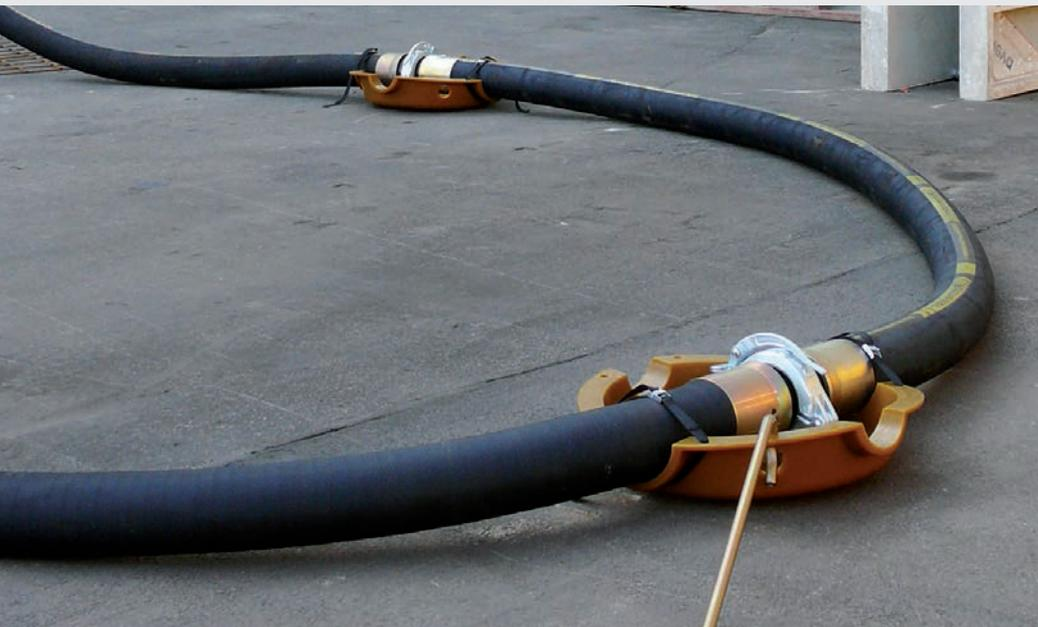
Das System ist aufgrund dieser Konstruktion nicht nur bestens für das Pumpen von Beton geeignet, sondern auch für die Förderung von Mörtel- und Estrichmischungen. Besonders pflegeleicht zeigt sich die PX-Leitung auch in der Reinigung. Ein mühsames Auskratzen der Dichtung entfällt. Wegen dieser Eigenschaften wird PX-Ultraflex® hauptsächlich für Schlauchleitungen eingesetzt, die häufig und schnell montiert und wieder zerlegt werden müssen.
