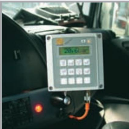
Die Mischerbedienung aus dem Fahrerhaus ist serienmäßig, Ausführung unterschiedlich in Abhängigkeit vom Pumpsystem
