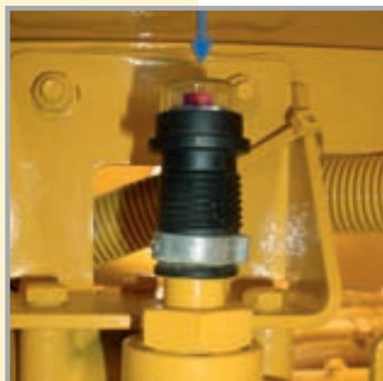
Eine einfache Sichtkontrolle, um festzustellen ob der Hydraulik-Hochdruckfilter verschmutzt ist
