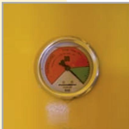
Wie stark die Saugfilter verschmutzt sind, erkennt man sofort auf übersichtlichen Anzeigen im Schaltschrank
