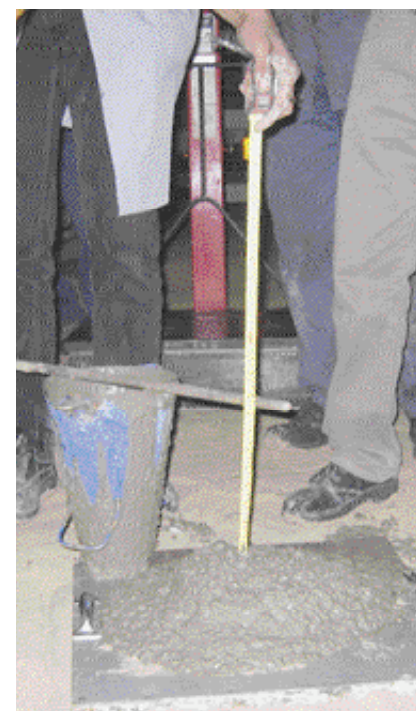
Kontrolle des Setzmaßes (slump) im Versuch
