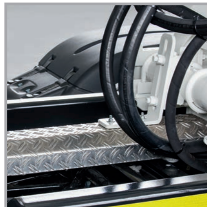
Die flexible Gelenkwellenabdeckung ist hochwertig und im Wartungsfall schnell zu demontieren.
