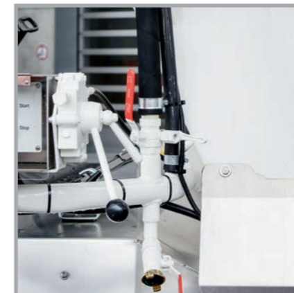
Bessere Zugänglichkeit und mehr Freiraum, selbst bei kurzen Radständen, durch die in den Leiterhalter integrierte Wasserleitung.
